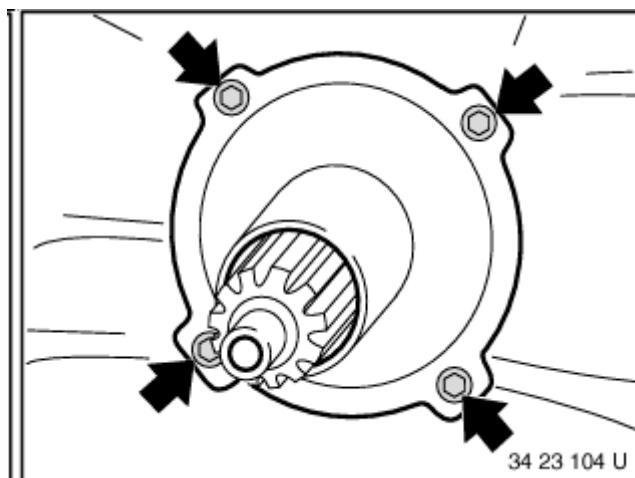
Schrauben lösen und Führungsrohr abnehmen.
