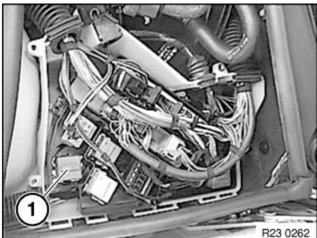
Das Relais (1) der Hydraulikpumpe abziehen.
