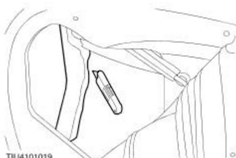
3. BEACHTE: Fensterführung und Abdeckung - Türschloss sind ein Bauteil. Dichtung zwischen Abdeckung - Türschloss und Türaußenblech durchtrennen.
