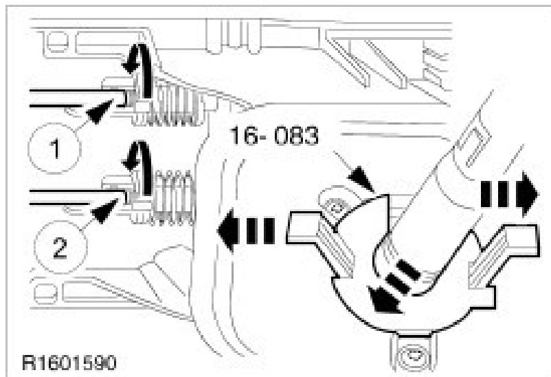
4. Einstellwerkzeug - Schalthebel bis Anschlag hineindrücken und verriegeln.
