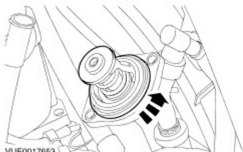
5. Thermostat gegen den Uhrzeigersinn drehen und Thermostat ausbauen.
