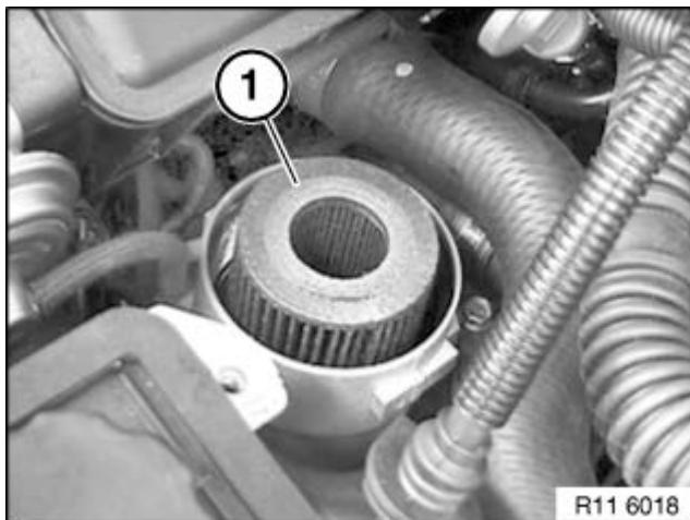
Den Ölfiltereinsatz (1) nach oben herausziehen und ersetzen.
