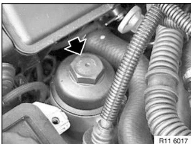
Den Hauptstrom-Ölfilterdeckel aufsetzen und festziehen.
