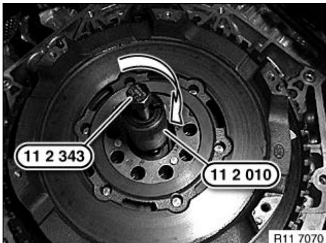
Spezialwerkzeug 11 2 010 im Rollenlager positionieren.
