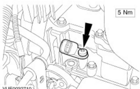
3. Schraube - CMP-Sensor festziehen.
