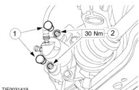
3. **BEACHTE:** Einbaulage des Bremsschlauchs für den Einbau notieren.
