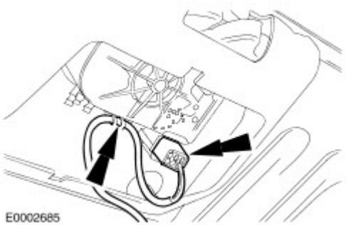
2. Stecker - Heckklappenverriegelung abziehen.
