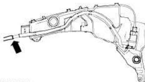
2. Schlauch - Pumpe - Scheinwerferwaschanlage trennen (falls vorhanden).
