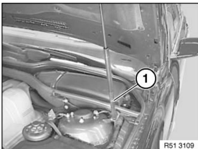
Spezialwerkzeug kann nur am Gehäuse (1) der Gasdruckfeder angewendet werden (dickes Teil).
