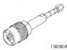
Abziehwerkzeug, Lager (Grundwerkzeug)
