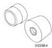
Einziehwerkzeug, vorderer Kurbelwellen-Dichtring
