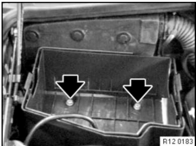
Schrauben lösen. Batterieträger ausbauen.
