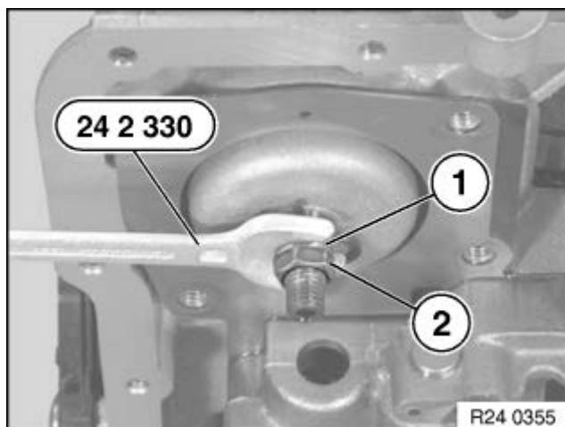
Servokolben am Stutzen (1) mit Spezialwerkzeug 24 2 330 gegenhalten und Kontermutter (2) lockern.
