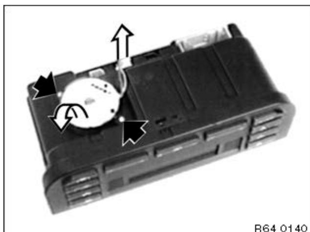
Stecker abziehen, Schrauben lösen und Fühlergebläse ausheben.
