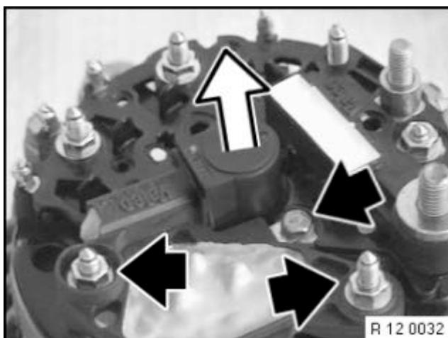
Die Schrauben lösen.
