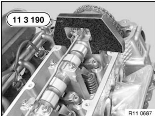
Nockenwelle mit Spezialwerkzeug 11 3 190 in Zünd-OT-Stellung des ersten Zylinders fixieren.
