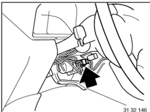
Steckverbindung (orange) aus der Halterung an der Lenksäule ziehen und trennen.
