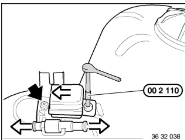
Steckverbindung trennen und Schrauben mit Spezialwerkzeug 00 2 110 lösen.
