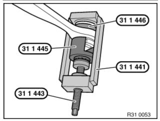
Radführungsgelenk mit Spezialwerkzeug 31 1 441 / 31 1 443 / 31 1 445 / 31 1 446 ausziehen.
