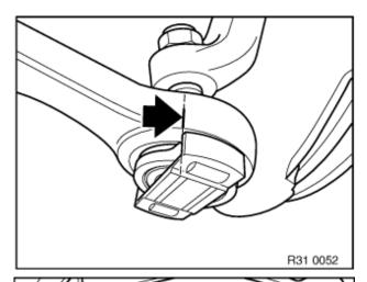
Die Einbaulage des Radführungsgelenkes am Querlenker zeichnen (Farbstrich). Mutter abschrauben.
