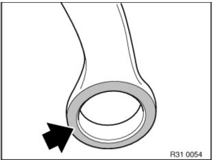
Die untere Fläche am Querlenker mit Schaber/ Drahtbürste entrosten und die Bohrung reinigen.
