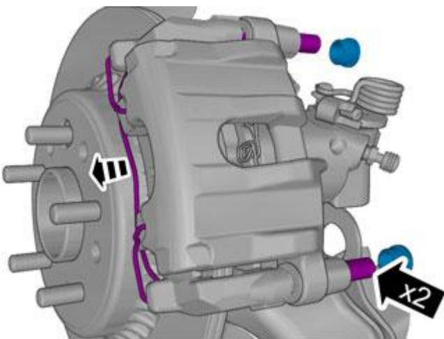
Anzugsdrehmoment: Gleitstange Bremssattel hinten, 35 Nm
