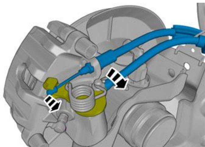
Anzugsdrehmoment: Bremsschlauch an Bremssattel hinten, 23 Nm
