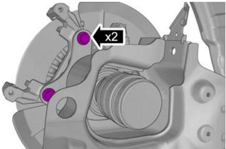
Anzugsdrehmoment: Bremssattel hinten im Längslenker, 70 Nm
