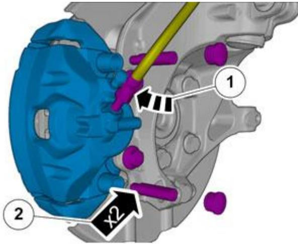
1. Anzugsdrehmoment: Bremsschlauch an Bremssattel vorne, 23 Nm
