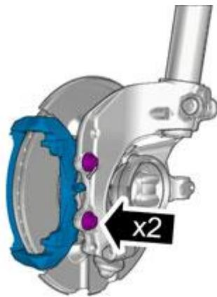
Anzugsdrehmoment: Bremssattel im Achsschenkel vorn, 120 Nm
