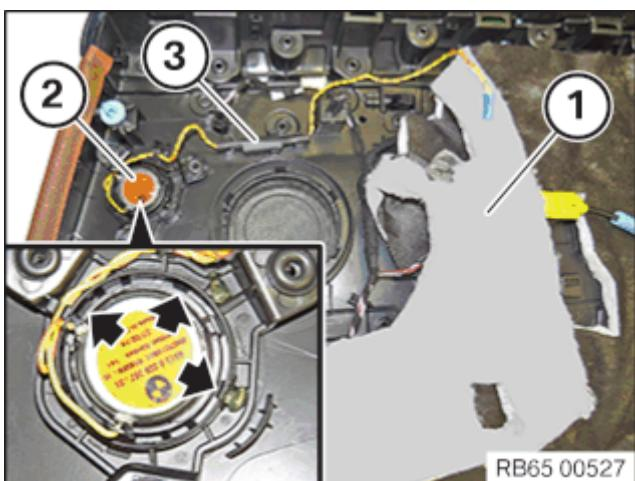
Widerstand (3) korrekt einclipsen.
