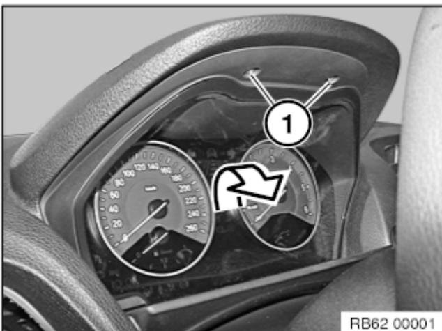
Die Instrumentenkombination entgegen der Pfeilrichtung fügen.
