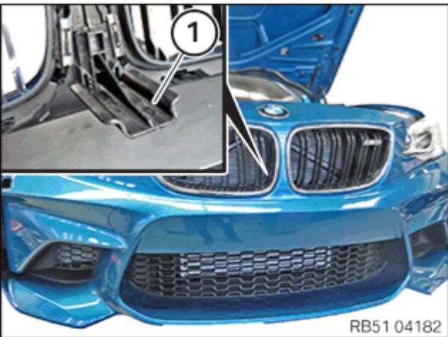
Abstützung (1) komplett nach unten verschieben, bis diese auf dem Träger aufliegt.
