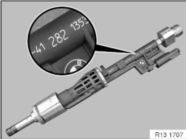
Wenn kein Injektormengenabgleich durchgeführt wird, ist es möglich, dass der Motor unrund läuft oder nicht startet.
