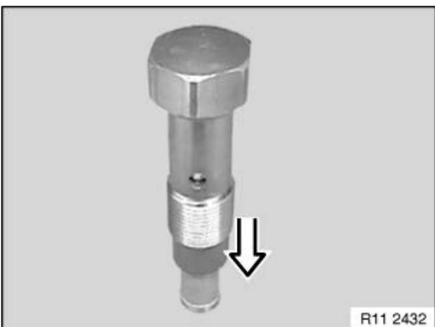
Wenn der Kettenspianner wieder verwendet wird, muss der Ölraum im Kettenspianner entleert werden.
