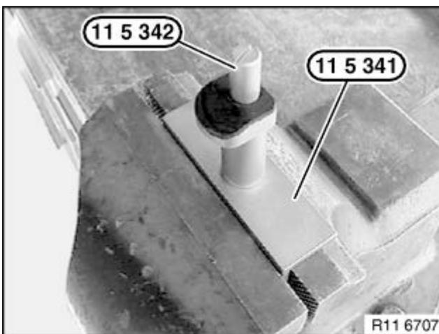
Spezialwerkzeug 11 5 341 in einem Schraubstock einspannen.
