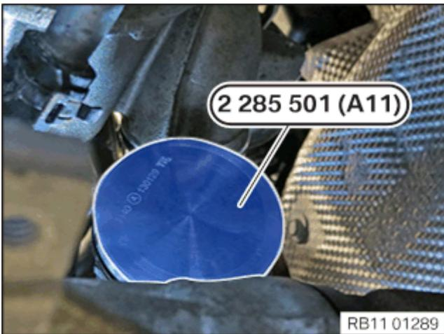
Druckschlauch mit dem Verschlussstopfen 2 285 501 (A11) zum Ladeluftkühler luftdicht verschließen.
