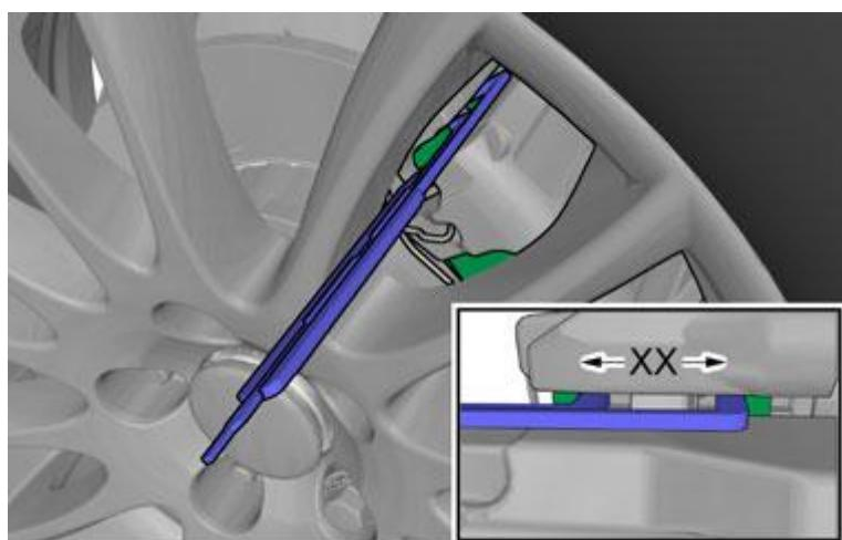
Spezialwerkzeug: **T9997437, 999 7437 Messwerkzeug**
