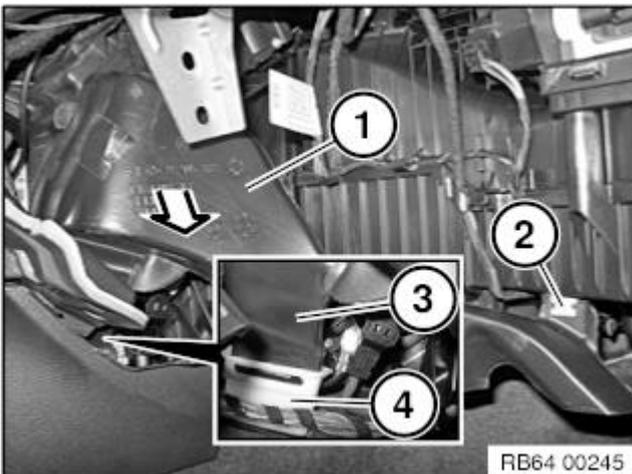
Luftkanal (1) an Haltespange (2) nach unten ausklippen.
