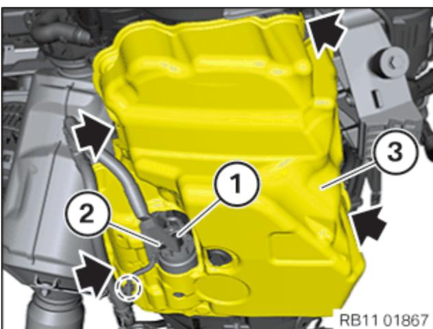
Schallisolierung (1) einbauen und mit den Spreiznieten befestigen.
