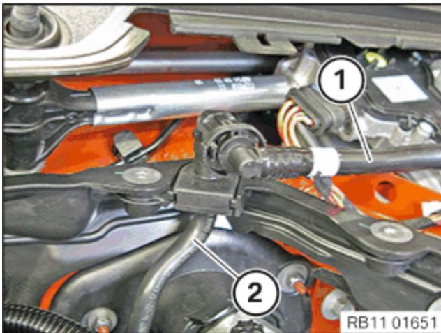
Unterdruckleitung (1) entriegeln und von der Unterdruckleitung (2) abziehen.
