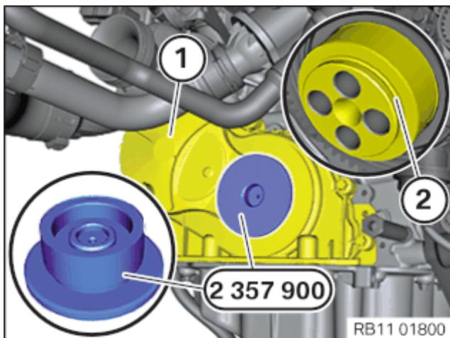
Spezialwerkzeug 2 357 900 mit Räderkastendeckel (1) auf Nabe Kurbelwelle (2) stecken.
