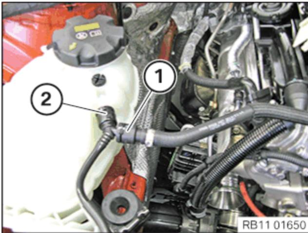
Kühlmittleitung (1) entriegeln und von der Kühlmittleitung (2) abziehen.
