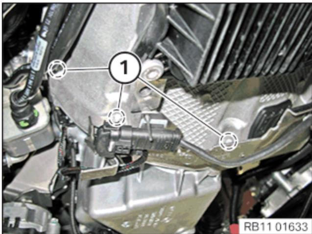
Schrauben (1) am Getriebe festziehen.
