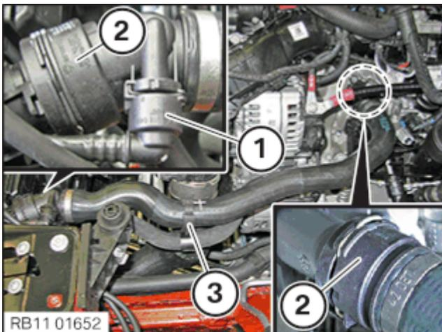
Kühlmittelrücklaufleitung (1) entriegeln und von der Kühlmittleitung (2) abziehen.
