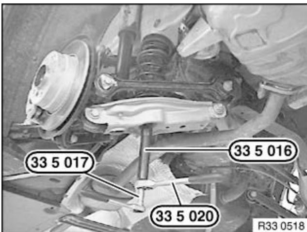
Schraubenfeder mittels Spezialwerkzeug 33 5 016 und 33 5 020 spannen, dabei Spindel des Federspanners mit Spezialwerkzeug 33 5 017 gegenhalten.
