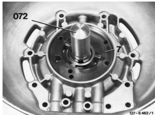
13 Zwei Stehbolzen M 8 (15) gegenüberliegend in das Pumpengehäuse einschrauben und die Primärpumpe einsetzen.
