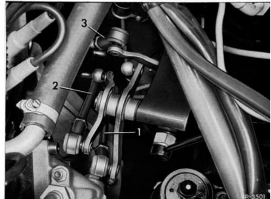
Schalthebel am Getriebebeschaltdeckel bei Lenkradschaltung
