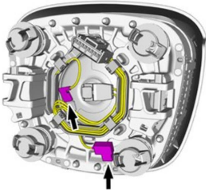
Die Steckverbinder lösen.
