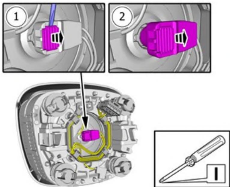
1. Die Verriegelung des Steckverbinder lösen.
