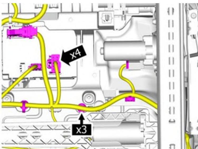
Die Steckverbinder lösen.
