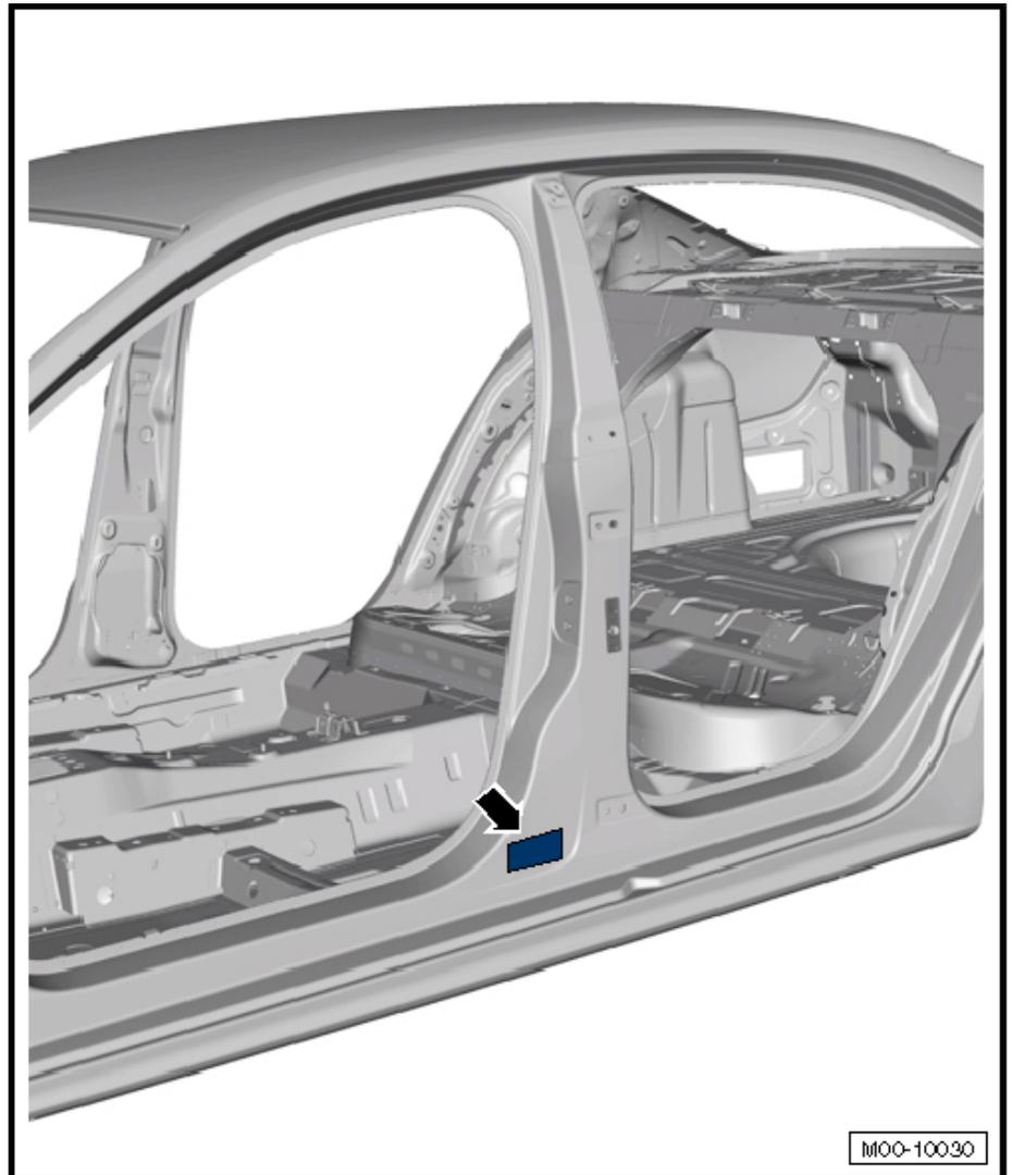
Das Typschild -Pfeil- ist links auf der B-Säule befestigt und nach dem Öffnen der vorderen Tür sichtbar.
