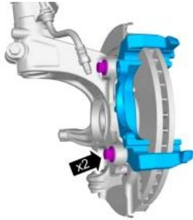
Anzugsdrehmoment: Befestigung Bremssattel vorne, 200 Nm
