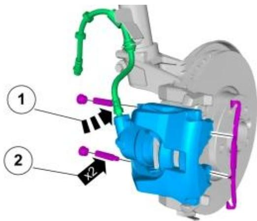
1. Anzugsdrehmoment: Bremsschlauch an Bremssattel vorne, 18 Nm
