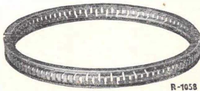
Bild 03/4 O-ring PC 98 bestehend aus 2 Lamellen mit verchromter Lauffläche und Ringfeder mit Radial- und Axialspannung
