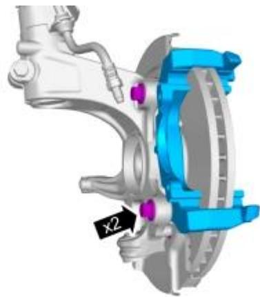
Anzugsdrehmoment: Befestigung Bremssattel vorne, 200 Nm
