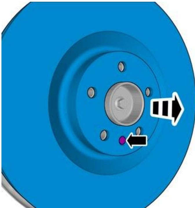
Anzugsdrehmoment: Bremsschreibe hinten an Radnabe, 10 Nm
