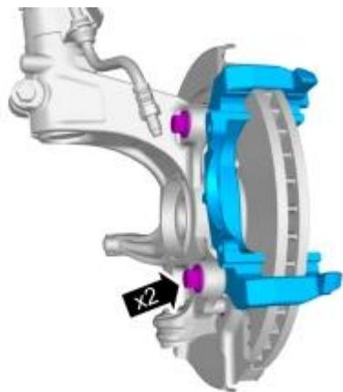
Anzugsdrehmoment: Befestigung Bremssattel vorne, 200 Nm
