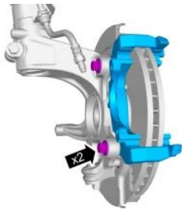
Anzugsdrehmoment: Befestigung Bremssattel vorne, 200 Nm
