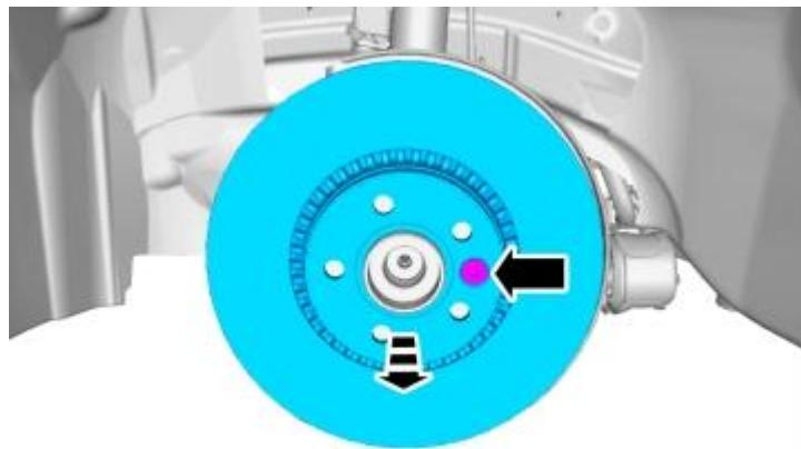
Anzugsdrehmoment: Bremsschreibe vorn an Radnabe, 35 Nm
