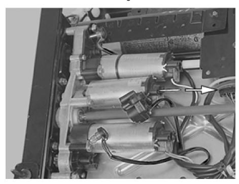
Die beiden Schrauben entfernen.
