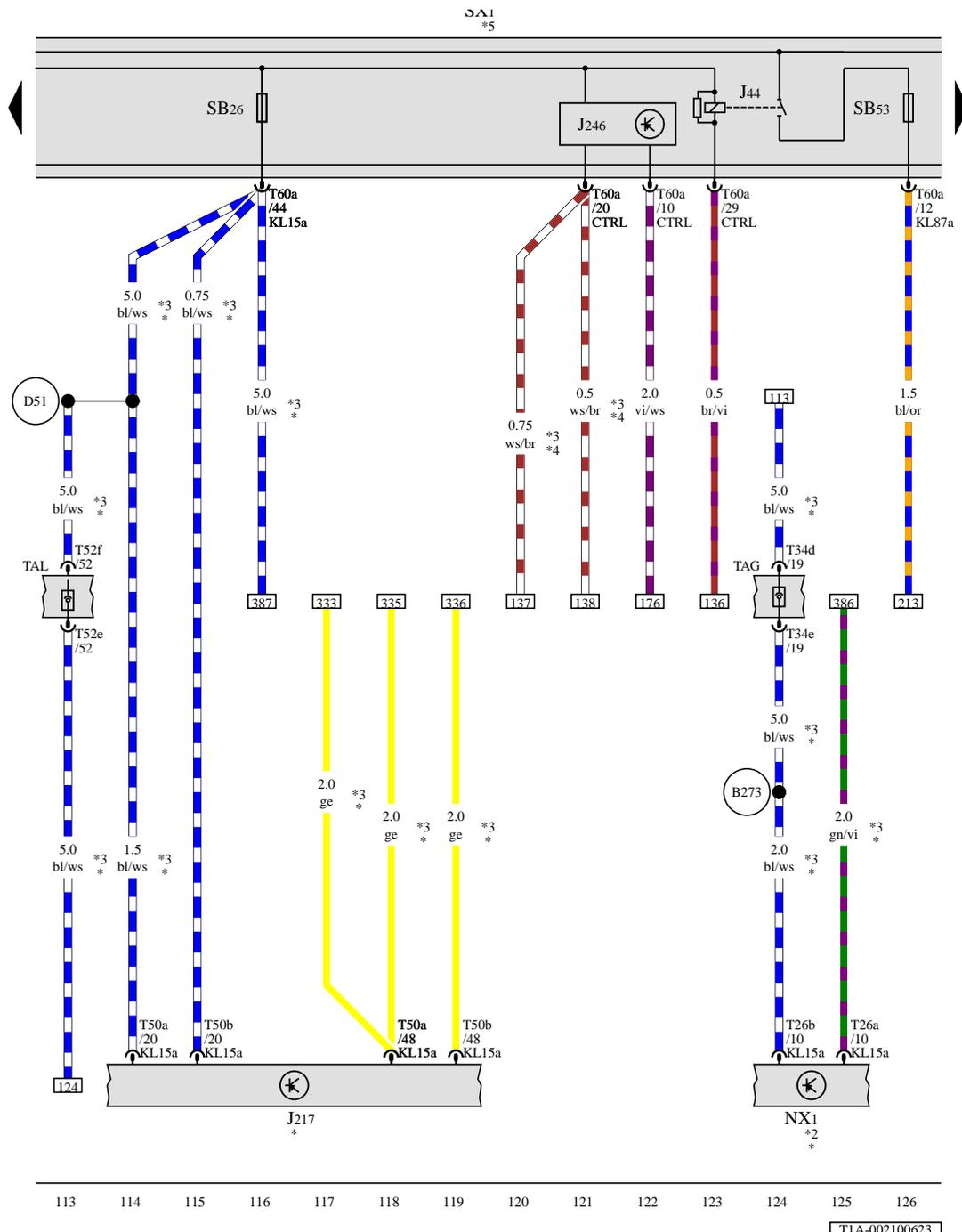
Relais für Magnetkupplung, Steuergerät für automatisches Getriebe, Abschaltrelais für Magnetkupplung der Klimaanlage, Getriebe, Anschluss- und Verteilerkasten 1
