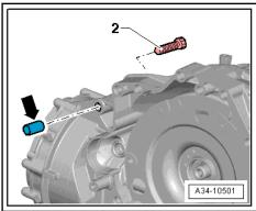
Die Distanzhülse muss zwischen Anlasser und Getriebe eingesetzt werden.
