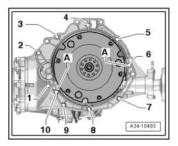
Transportsicherung -T40170- und Montagehilfe -T40169entfernen.
