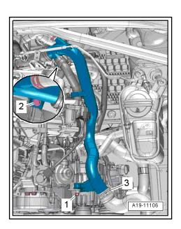
Kühlmittelschlauch abbauen, dazu Schlauchschelle -3- lösen.
