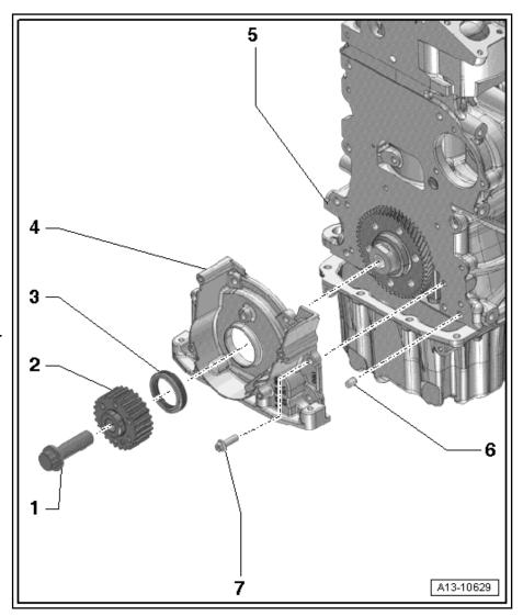
Dichtflansch Riemenscheibenseite - Anzugsdrehmoment und reihenfolge
