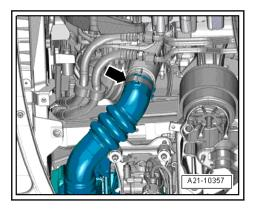
Mutter -Pfeil- am Längsträger rechts herausdrehen und Masseleitung frei legen.
