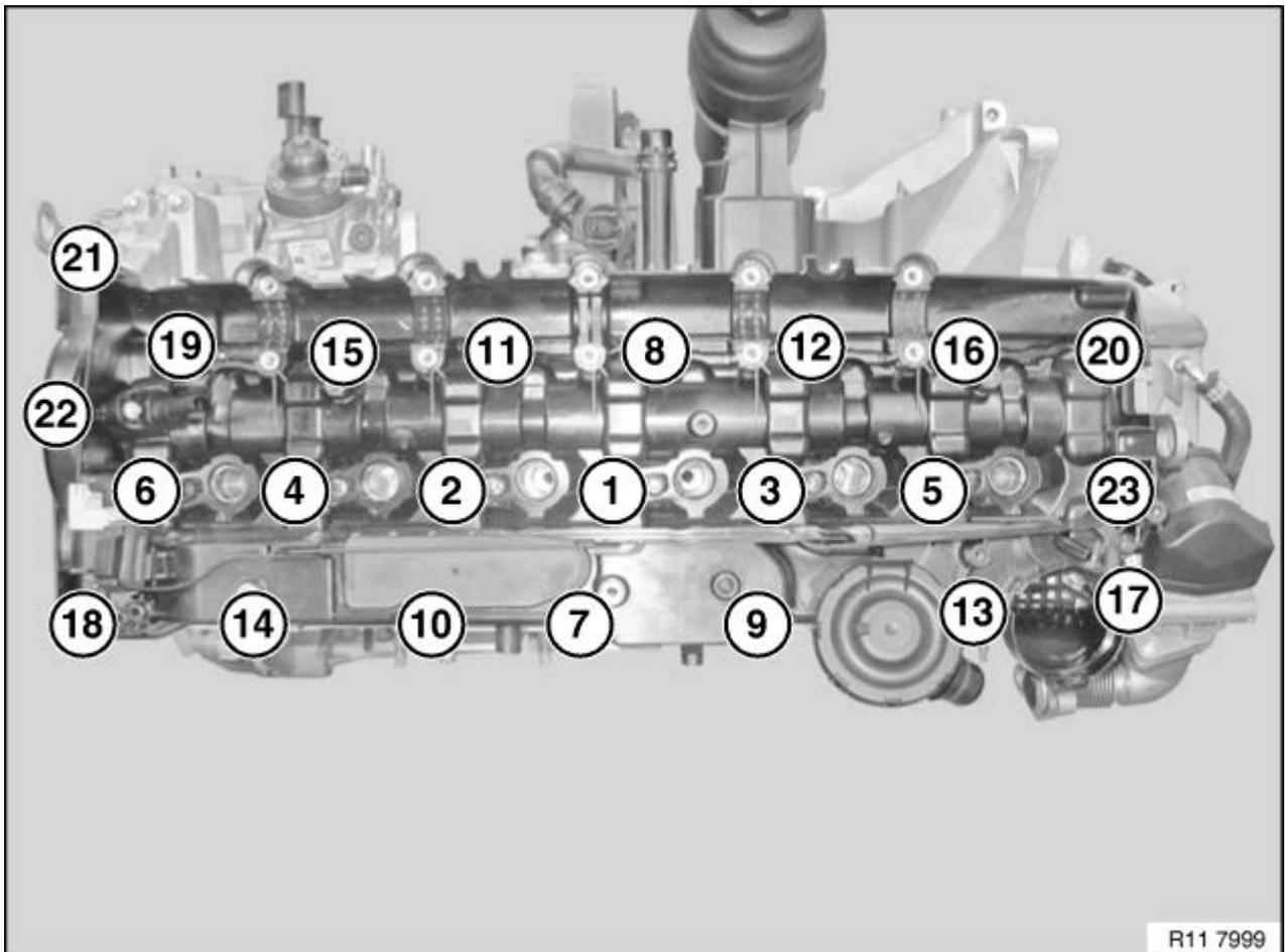
Schrauben der Zylinderkopfhaube in der Reihenfolge 23 bis 1 lösen.
