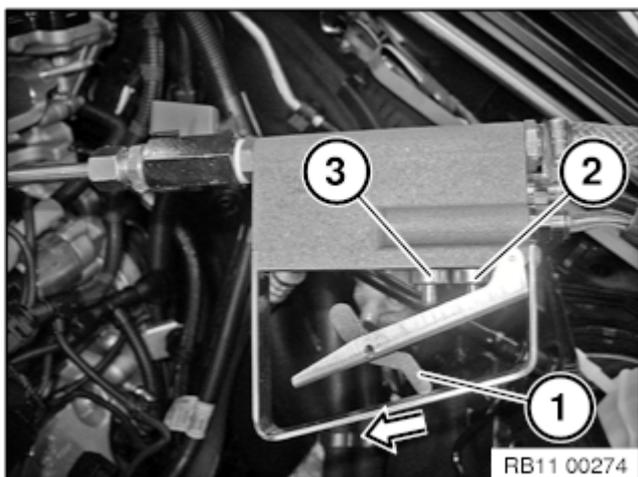
Sicherungshebel (1) in Pfeilrichtung nach vorn schieben.
