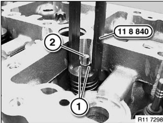
Ventilkeile (1) vom Ventil (2) mit einem Magnet ausbauen.
