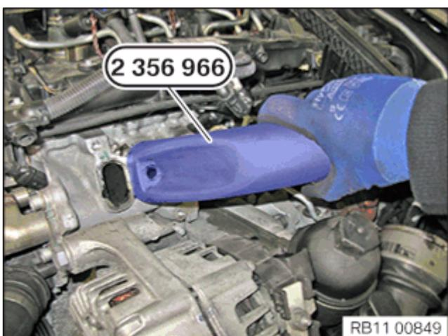
Reinigung Tangentialkanal 1. Zylinder:
