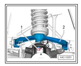
Querlenker oben -2- vom Radlagergehäuse mit Kugelgelenkabzieher -T40140- abdrücken und Mutter abschrauben.
