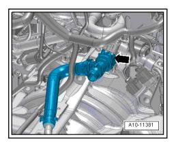
Schrauben -Pfeile- herausdrehen, Wärmeschutzblech für Gelenkwelle links abnehmen.
