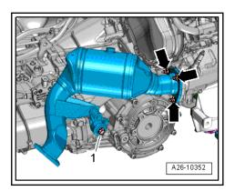
Anschlussstutzen vom Kühlmittelrohr oben abbauen, dazu Halteklammer -Pfeil- anheben.
