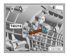
Schrauben -1- herausdrehen und Deckel für Schaltwelle -2vorsichtig abhebeln.
