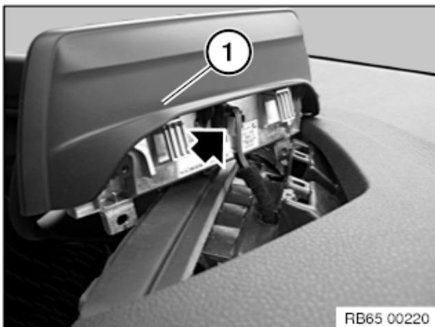
Steckverbindung entriegeln und trennen.
