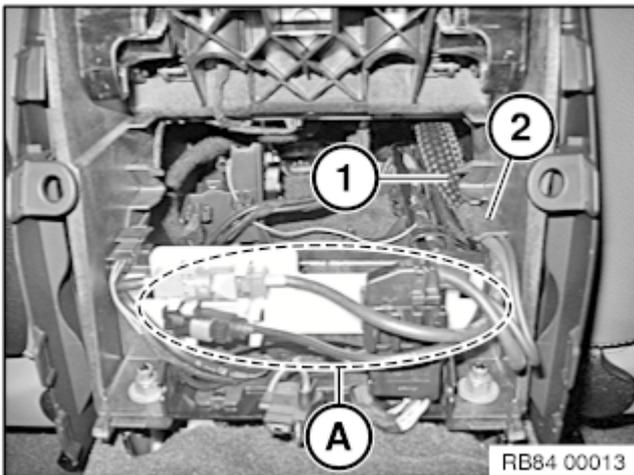
Zugehörige Steckverbindungen in Bereich (A) entriegeln und trennen.
