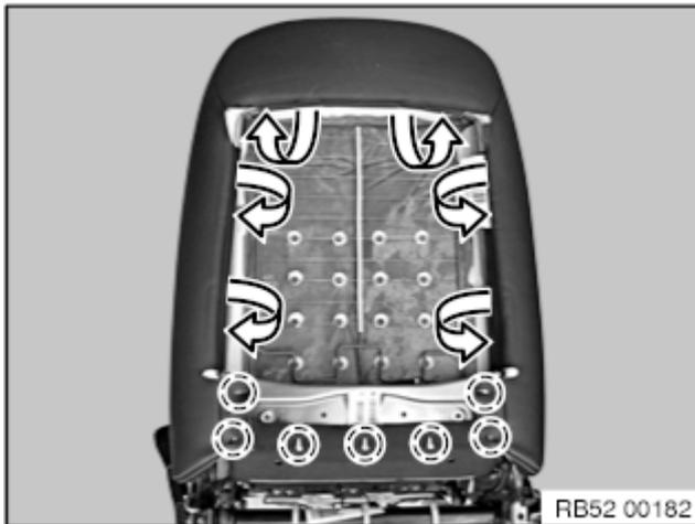
Keder vom Rückenlehnenrahmen ausheben. Rückenlehnenbezug unten im markierten Bereich von Metallaschen aushängen. Abspannlappen mit Schaum vorsichtig durch Spalt Rückenlehne und Sitzstruktur schieben. Ggf. Kabel vorsichtig durch Sitz- und Rückenlehnenmechanik führen, da die Kanten des Gestells scharf sein können.
