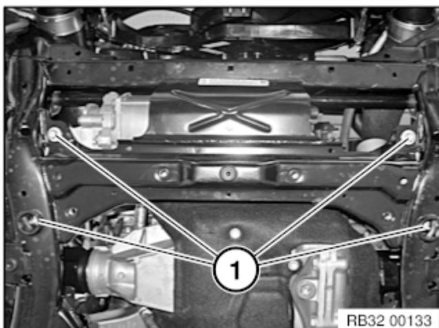
Schrauben (1) an Vorderachsträger lösen.
