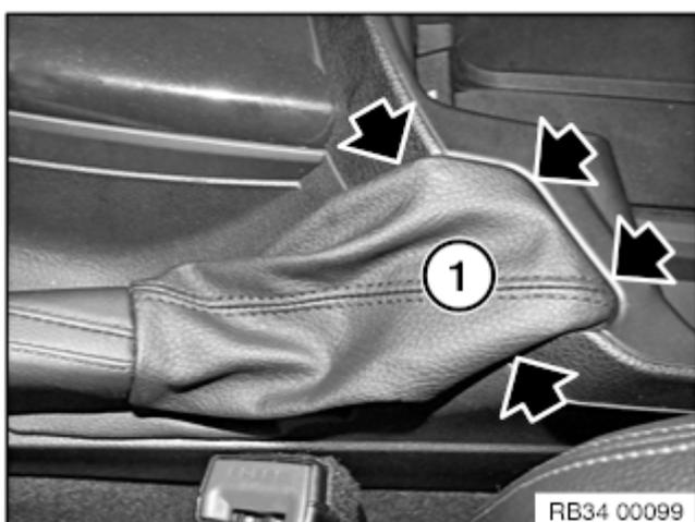
Faltenbalg (1) zuerst unten einführen und anschließend oben einclippen.
