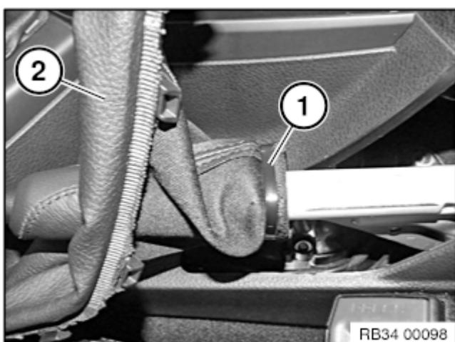
Faltenbalg (2) über Feststellbremshebel ziehen und mit Kabelbinder (1) befestigen.
