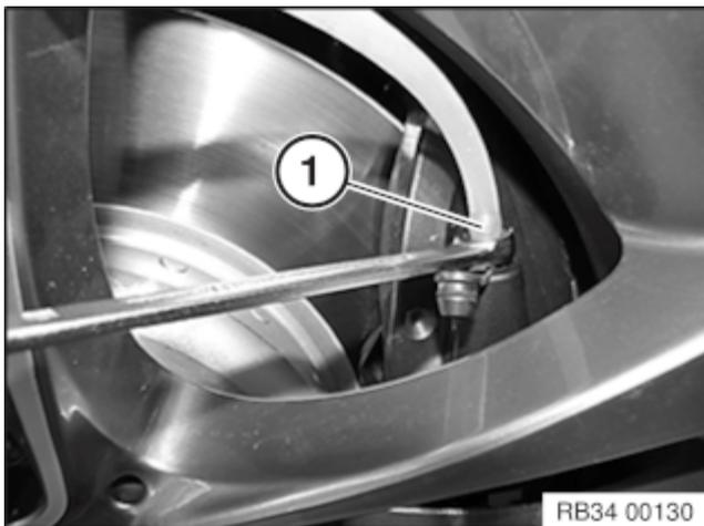
Bremssystem vorn rechts außen komplett spülen.
