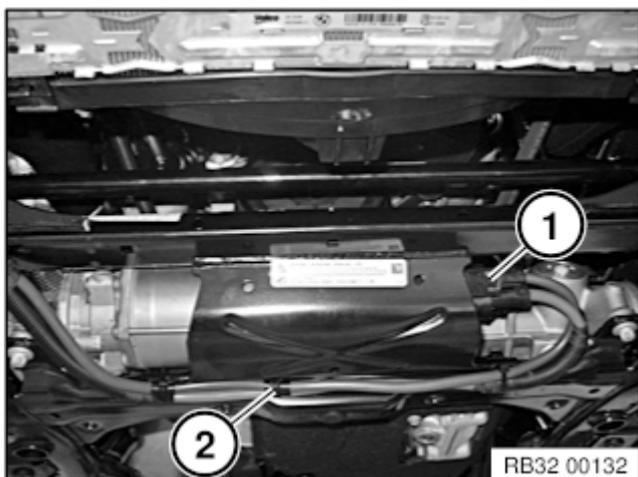
Steckverbindungen (1) entriegeln, trennen und Kabelbaum (2) am Vorderachsträger ausclipsen und zur Seite legen.
