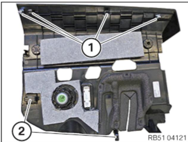
Klammern 1 und Führungen 2 auf Beschädigungen prüfen.
