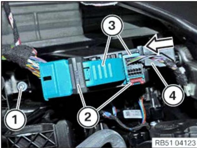
Airbagsteuergerät 4 entgegen Pfeilrichtung im Halter positionieren.
