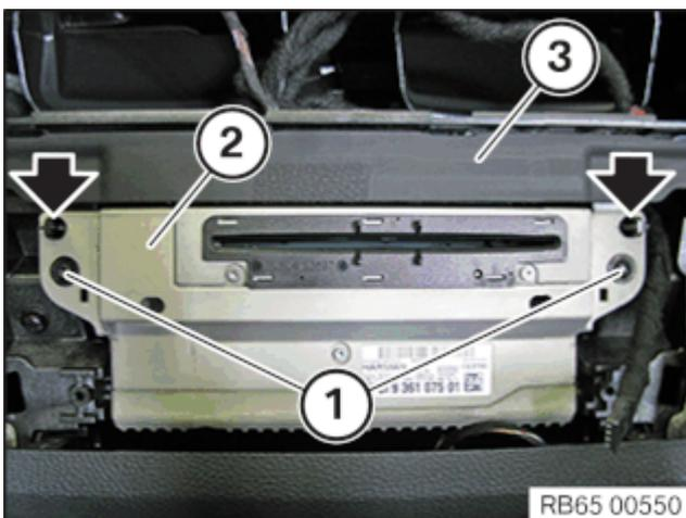
Headunit High (2) nach hinten in die Instrumententafel (3) schieben.
